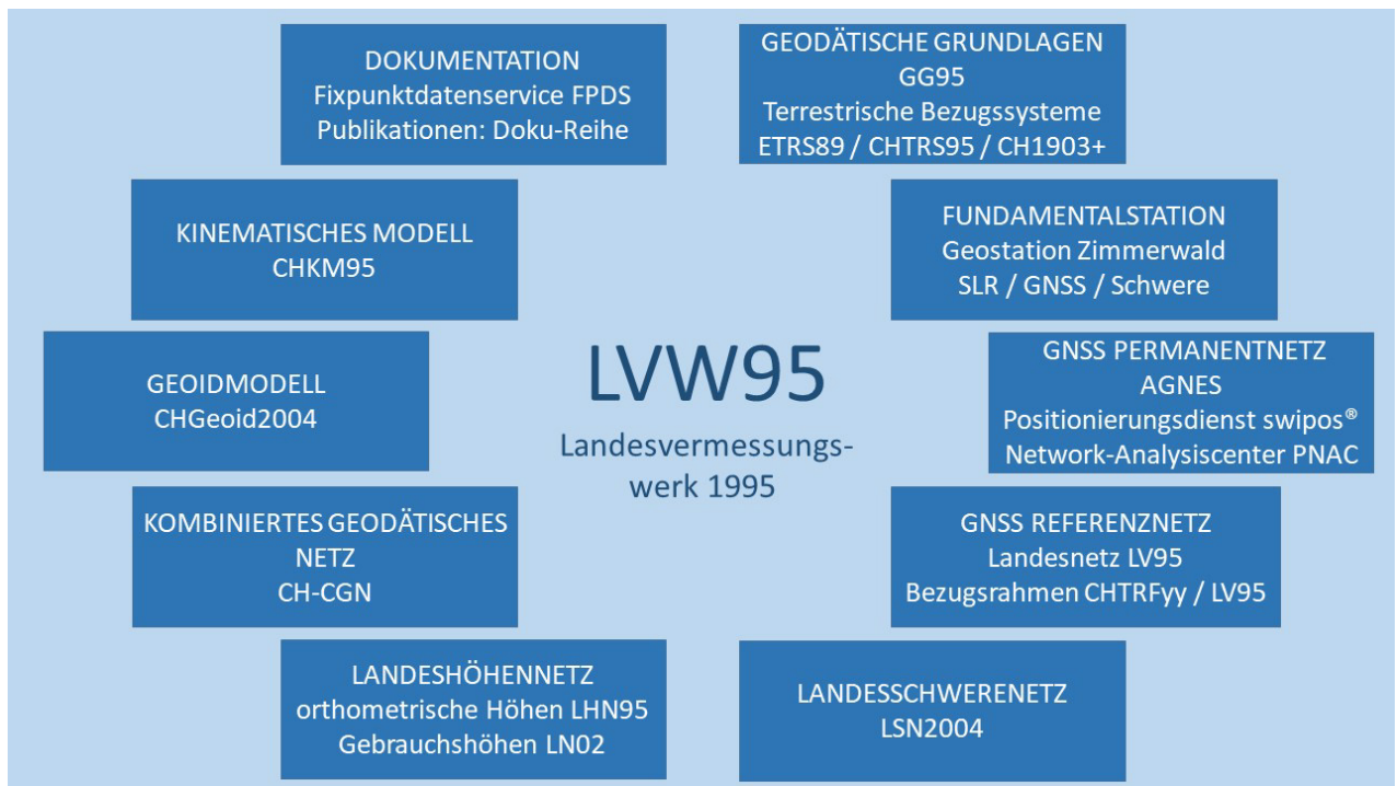
Abbildung 2-1: Schema der Komponenten des Landesvermessungswerkes LVW95
