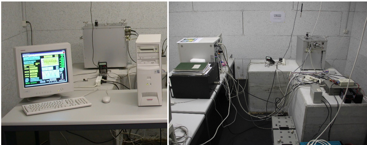
Abbildung 2-10: Geostation Zimmerwald: Schwerestation mit Gezeitengravimeter
