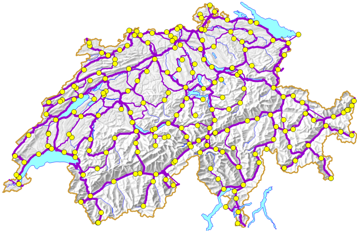
Abbildung 2-38: GNSS/Nivellement-Punkte der Schweiz
