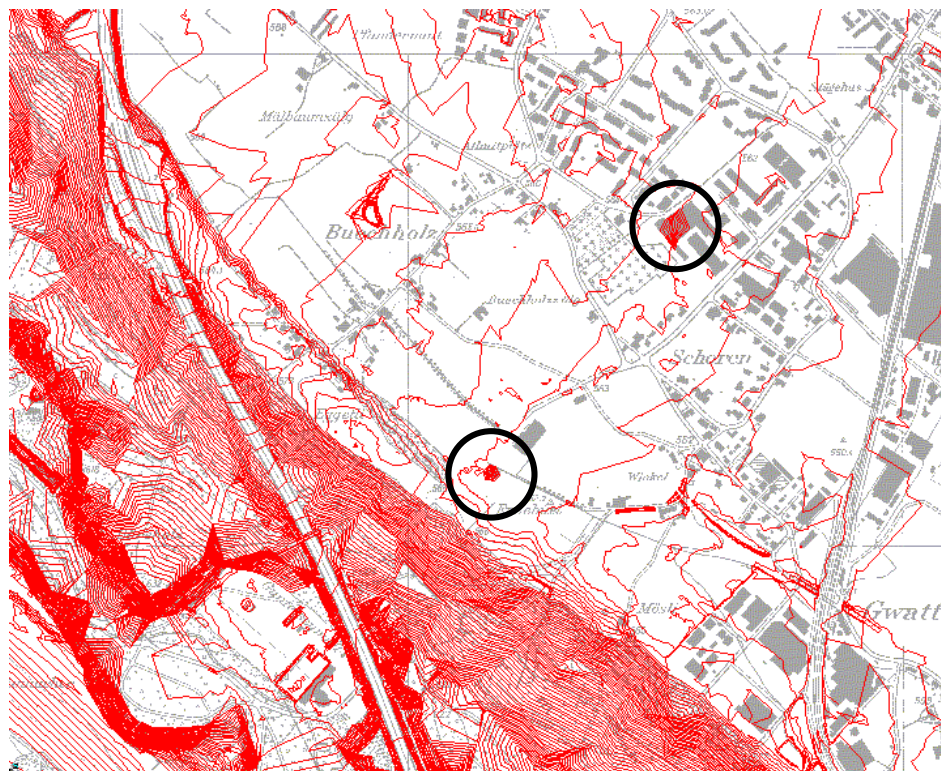
Abbildung 5: Höhenkurvenbild mit sehr kleiner Aequidistanz
