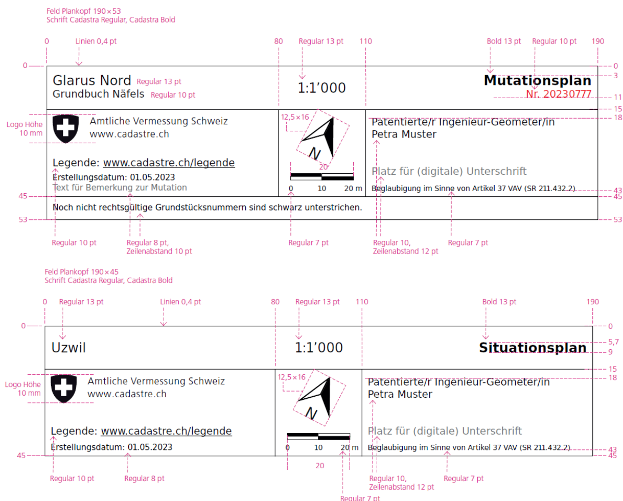
Abbildung 2: Vorlage Beschriftungsfeld (Vermessung in mm)
